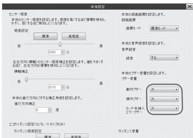
映像を記録する時などに鳴る動作ブザー、またはイベント（操作）ブザー、カード未挿入時のエラーブザーの音量を指定します。
